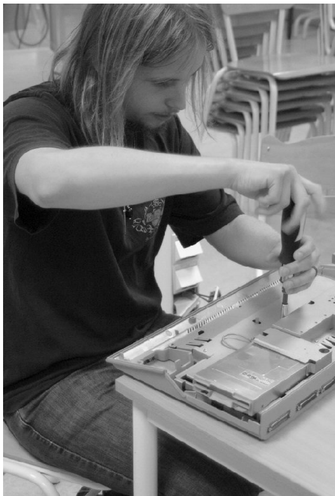
Fredrik Lindroth strappar ner sin STe för att komma åt SIMM-socklarna.
