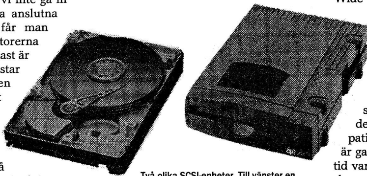
Två olika SCSI-enheter. Till vänster en vanlig hårddisk, och till höger den populära Zip-driven, som kan spara upp till 100 MB på löstagbara skivor.
